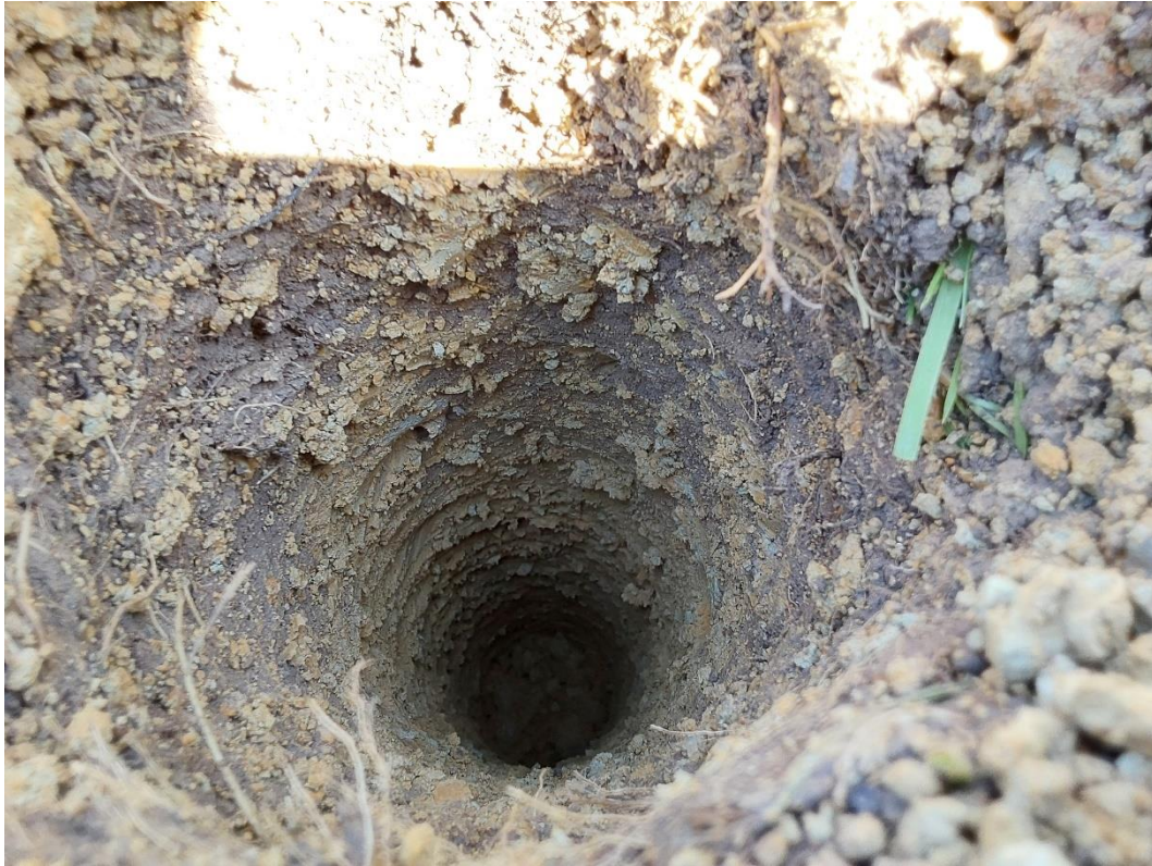
Slika 4: Izvedena krajša vrtina za namene izvedbe nalivalnega testa
